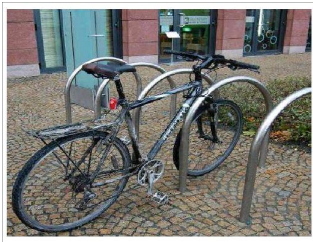
Obr. 2: Stojany pro střednědobé parkování typu obrácené U
